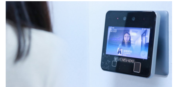
人臉辨識機整合考勤系統，可以即時完成上下班打卡作業。
