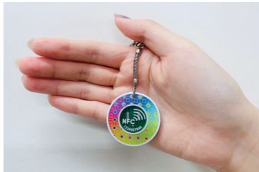
Stratasys 3D列印結合NFC或RFID，可製作悠遊卡、電子名片和門禁卡等3D列印電子產品。
