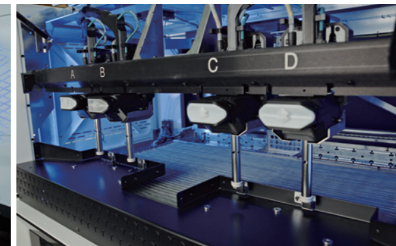
圖左：MAX系列手持雷射3D掃描以大面積掃描搶攻大尺寸零部件市場，最大掃描工件尺寸達15m。圖右：Stratasys全新F3300 3D列印機內部具有四個噴頭，具高速、高準確和可靠性。
