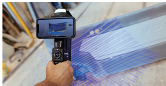
MAX系列手持雷射3D掃描器，可搭載手機監控遠端電腦桌面，協助擷取更多細節。
