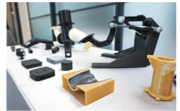
通業技研推Stratasys 複合材料碳纖維3D列印，應用生產加工和製造輔助工具。
