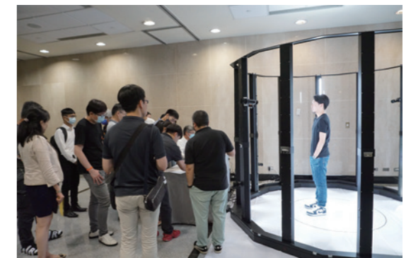
通業技研客製化研發的環景陣列3D掃描，讓顧客體驗高效的3D人像數位擷取，可應用於AR/VR或輸出成3D列印商品。
