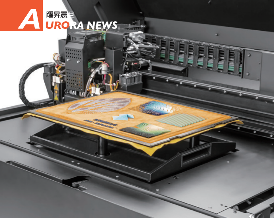
左：Stratasy J850™ TechStyle™運用7種不同材料直接進行全彩列印，擁有精緻細節的透明度和紋理，為時尚產業帶來歷史性的變革。右：Goldstein 與 Stratasy 合作，透過直接紡織3D列印結合工藝刺繡，訂製日式風格連衣裙時裝設計。
